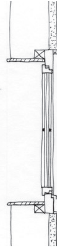
Neues Fenster mit Wärmedämmputz (auch mit Rahmendoppel möglich)
