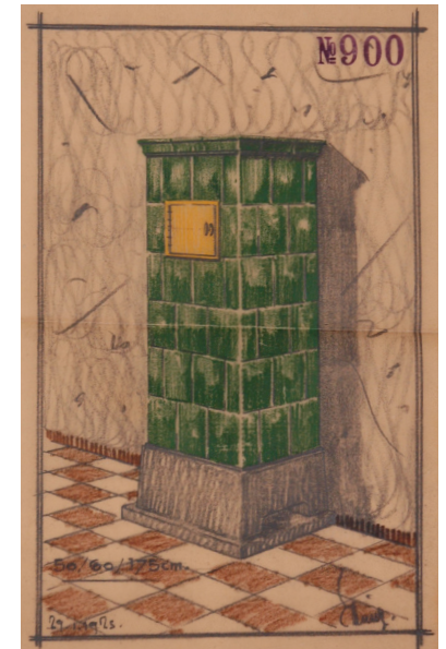
Kachelofen der bauzeitlich eingebaut war. Ofen der Firma Fritz Lang & Cie, Winterthur.
